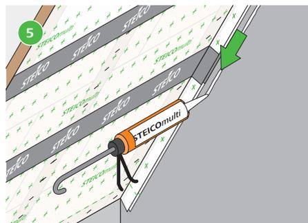
Der Anschluss der Dampfbremse an raue oder mineralische Untergründe kann mit der dauerelastischen Klebe- und Dichtmasse STEICO*multi* *connect* ausgeführt werden.
