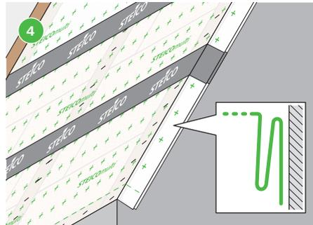
Die Dampfbremse mit Entlastungsfalte verlegen, damit Bauteilbewegungen aufgenommen werden können.
