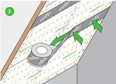
Das Hochleistungsklebeband STEICO*multi* *tape F* oder STEICO*multi* *tape P* mittig auf der Überlappung der Dampfbremse ansetzen, Zug um Zug last- sowie faltenfrei verkleben und fest anreiben.
