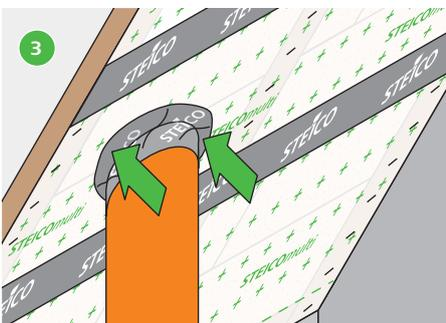
Durchdringungen wie Kabel und Rohre können ebenso mit dem Hochleistungsklebeband STEICO*multi* *tape F* abgedichtet werden. Dabei das Klebeband jeweils zur Hälfte auf der Durchdringung und zur anderen Hälfte auf der Dampfbremse zug- und faltenfrei verkleben.
