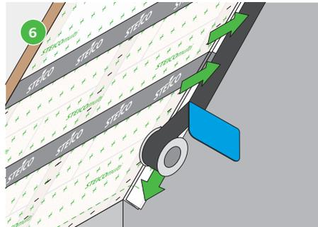
Alle Trennfolienstreifen von STEICO*multi* *tape black* abziehen, das Band mittig über der Verbindungsstelle ansetzen und Zug um Zug verkleben. Kräftig anreiben.
