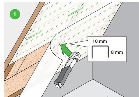
Die Dampfbremsbahn ausrollen, mit der bedruckten Seite dem Verarbeiter zugewandt verlegen und mit Tackerklammern (ca. 10 mm breit, 8 mm lang) alle 10 bis 15 cm befestigen – von oben nach unten arbeiten.
