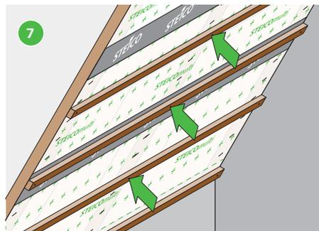
Sofern die Gefahr des Herausfallens des Dämmstoffs besteht (z.B. bei Dach- oder Deckenkonstruktionen) ist zur Aufnahme des Dämmstoffgewichts unmittelbar nach der Montage der Dampfbremsbahn eine zusätzliche mechanische Befestigung anzubringen (z. B. eine Lattung).
