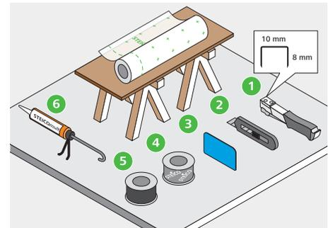
Der Zuschnitt der Dampfbremsbahn erfolgt mit einem scharfen Messer oder einem anderen dafür geeigneten Schneidwerkzeug.
