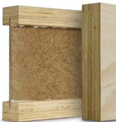
Steghöhe definiert wird, gilt: Je höher er ist, desto mehr Material wird gegenüber Rechteckquerschnitten eingespart. So lassen sich top U-Werte kostengünstig realisieren – zumal der schlanke Steg die Wärmebrücken stark reduziert und das Element deshalb außen nicht überdämmt werden muss.
