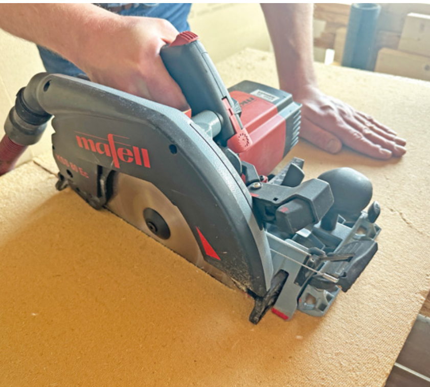
Zum Zuschneiden der robusten Holzfaser-Putzträgerplatten sind schienengeführte Handkreissägen mit grober Zahnteilung und Staubabsaugung ideal.
