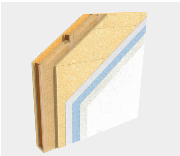
Holzrahmenkonstruktionen mit Plattenwerkstoff außen
